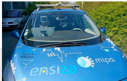
Figure 1: Prototype SMART-UHA et véhicule ARTEMIPS équipé d'une caméra light-field, d'une caméra monoculaire, de Lidars et d'une centrale inertielle.
